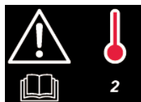
Foutcode 2: Als de temperatuur in de regelenheid boven 65 °C/149 °F stijgt, schakelt het apparaat uit. Automatische reset wanneer de temperatuur onder 55 °C/131 °F daalt.
