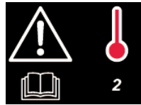
Fehlercode 2: Wenn die Temperatur innerhalb des Steuergeräts über 65°C/149°F steigt, schaltet sich das Gerät aus. Automatisches Zurücksetzen, wenn die Temperatur unter 55 °C/131 °F fällt.
