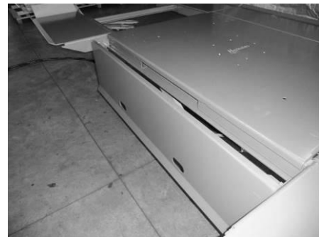
Bild 7 / 8: Zwischenfahrbahn in Grundstellung / Zwischenfahrbahn abgeklappt.
