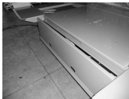
Fig. 7 | 8: Corsia di marcia intermedia in posizione di base / Corsia di marcia intermedia sollevata.
